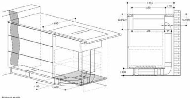
Vue de côté avec kit de recyclage d'air par conduit Profondeur du plan de travail de 700 mm ; encastrement affleurant
